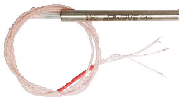
Термометр сопротивления платиновый вибропрочный эталонный (капсульный) ПТСВ-2-2, ПТСВ-2-3, ПТСВ-6м-3, ПТСВ-7м-2
